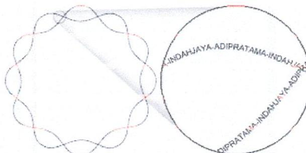
7. Contoh *security printing* teknik *Line Width Modulation*.
